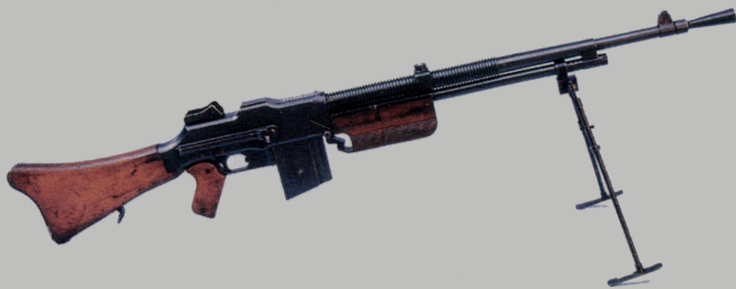
Version polonaise du BAR : le fusil-mitrailleur wz 28, ici dans sa version tardive, fabriquée à Radom en 1933, munie d'une crosse «queue de poisson» et d'une embase pour hausse antiaérienne sur le canon.
